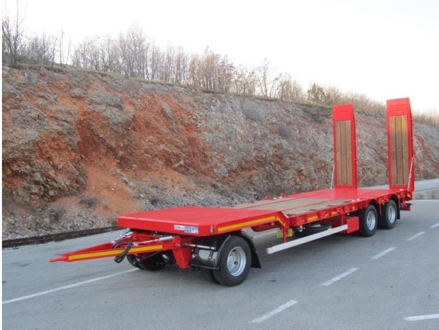
Slika br. 4. Niskonoseća prikolica nosivosti 30t
