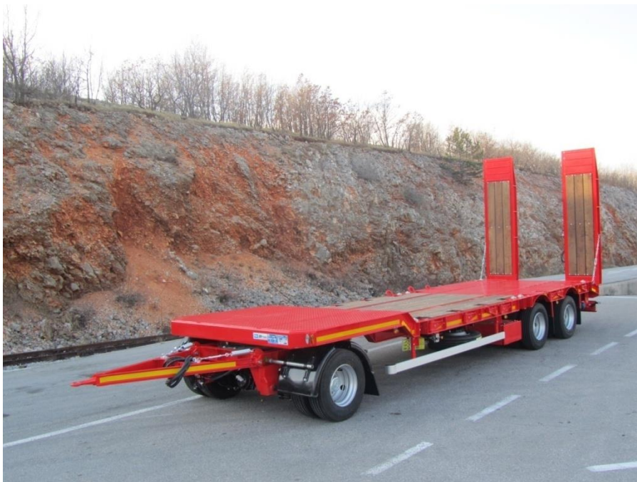
Slika br. 4. Niskonoseća prikolica nosivosti 30t
