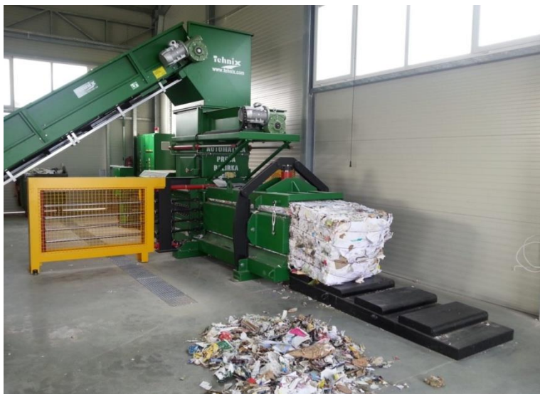
Slika br. 2. Automatska presa sa balirkom
